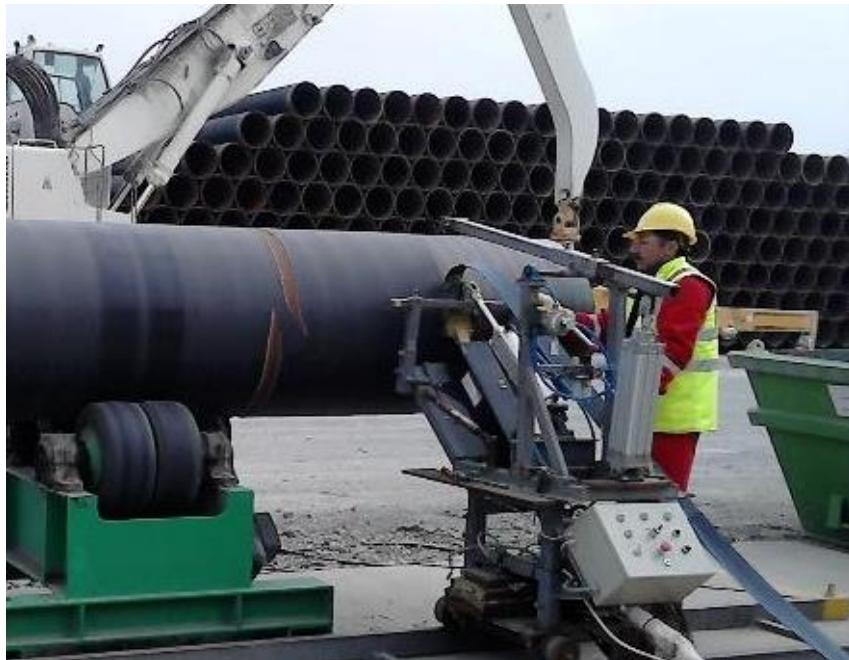
通過使用 RPR 感應去除管道工程中廢棄管道上的塗層，可以有效地進行剝離，確保快速重新引入塗層生產線。
